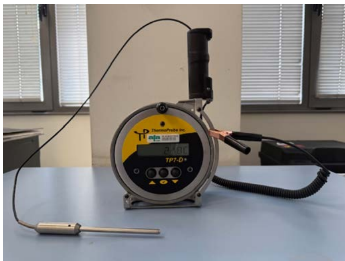
Снимка 2: Калибрирана термосонда за измерване на температура на гориво в резервоар
