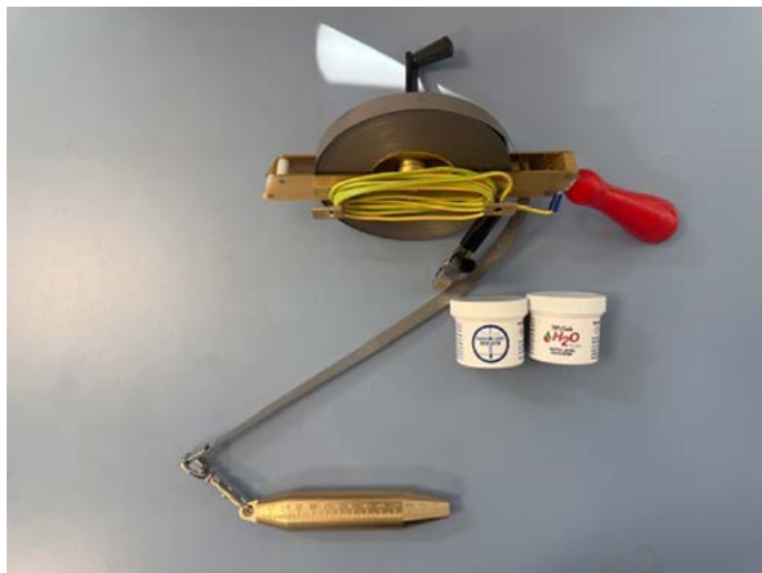
Снимка 2: Измервателна ролетка с лот и индикаторни пасти за измерване ниво на гориво в резервоари
