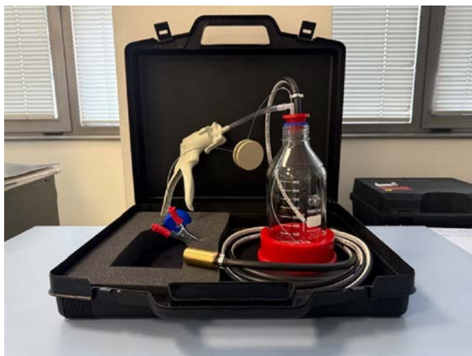
Снимка 1: Пробоотборник EX с помпа за взимане на проби от органични течности
